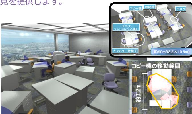
超高層建物上階のオフィスにおける地震時の家具の挙動評価
