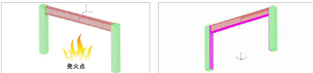
図7 热輻射を受ける鉄骨構造のモデル化（鋼材の内側に熱輻射要素を配置）
