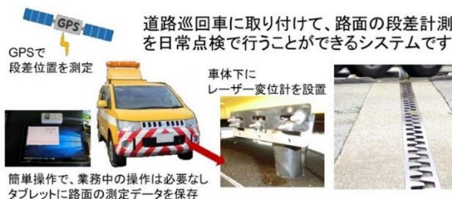
図5 高速道路の段差計測システム J-DAnswer
