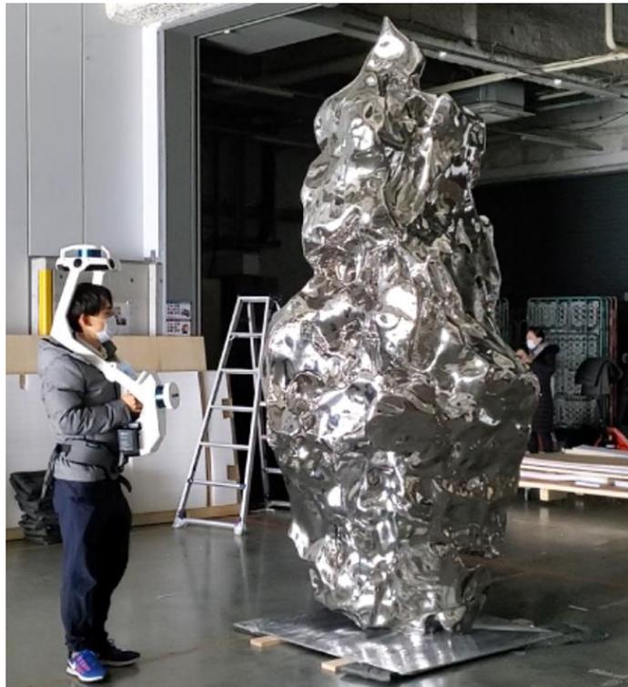
ジャン・ワン《Artificial Rock. No. 109》(2015年)を NavVis で計測する様子
