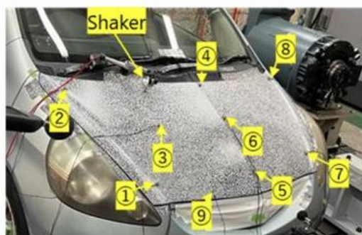
図 9. 自動車のボンネットの計測の様子 [5]
