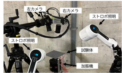
図 5. 加振試験の計測セットアップ [4]
